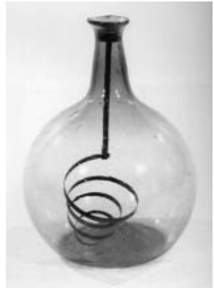
Abb.1 Verbrennung einer stählernen Uhrfeder in reinem Sauerstoff. (Aus: Krätz, O.: 7000 Jahre Chemie, Callwey, München 1990, S. 220)
